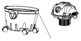
Déverrouiller les clips de verrouillage pour ouvrir le couvercle
