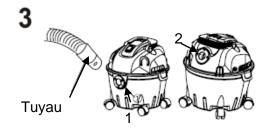
Connecter le tuyau à l'emplacement 1 pour la fonction « aspiration »
