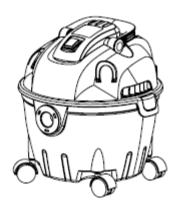
Refermer le couvercle à l'aide des clips de verrouillage
