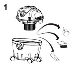
Soulever le boitier supérieur en déverrouillant les clips situés de part et d'autre de l'appareil.
