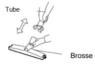
Insérer le tube dans la brosse avec un mouvement de rotation
