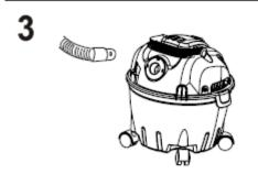
Insérer le flexible dans le connecteur (à l'emplacement 1 ou 2 suivant la fonction désirée *(cf. paragraphe 3. Installation)*). Appuyer sur l'interrupteur pour mettre en marche l'appareil.
