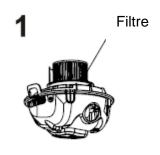
Déverrouiller les clips de verrouillage pour ouvrir le couvercle.
